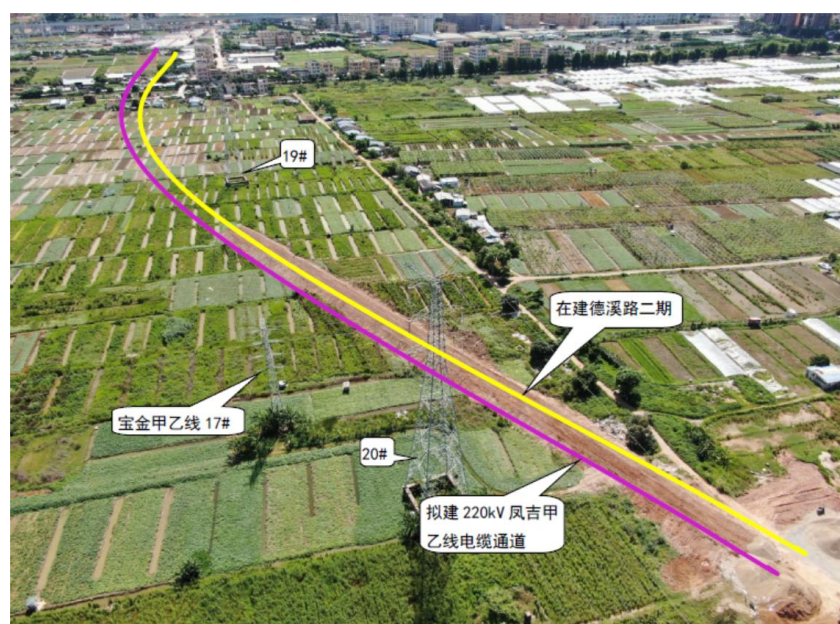
图 2.3-3 拟建电缆通道平面及现场布置（三）
