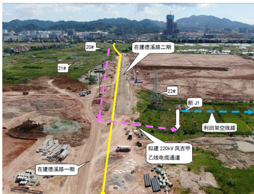
图 2.3-4 拟建电缆通道平面及现场布置（四）
