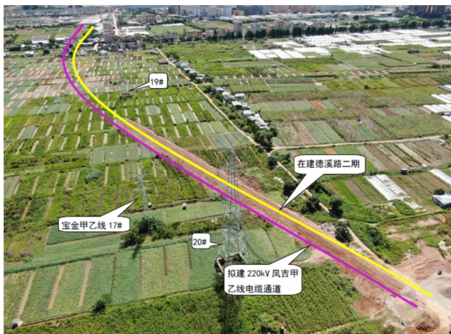
图 1.2-4 拟建电缆通道平面及现场布置（三）
