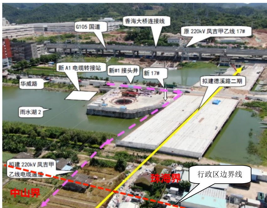
图 1.2-2 拟建电缆通道平面及现场布置（一）
