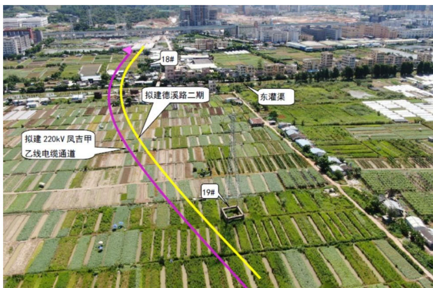
图 1.2-3 拟建电缆通道平面及现场布置（二）
